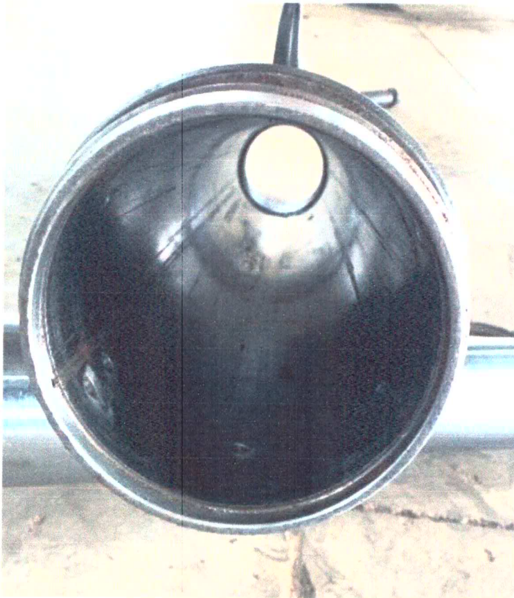
(parte interna cilindro onde gerava atrito e riscou a peça)
