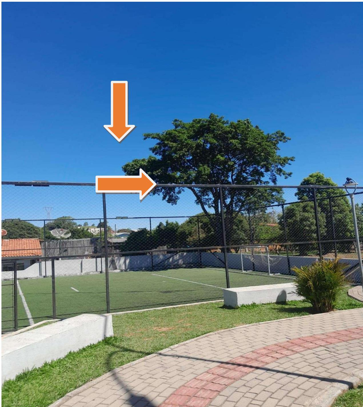
Instalar tela galvanizada altura de 3 metros todo o perímetro do campo e cobrir com tela conforme memorial descritivo.
