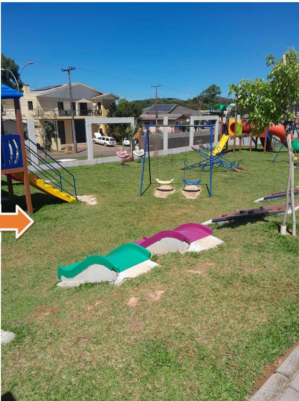
Remover a grama e fazer base de concreto espessura 10 cm e colocar grama sintética em aproximadamente 70 m<sup>2</sup>.
